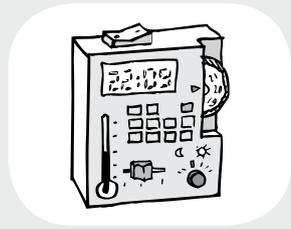
➤ C'est un appareil qui va gérer automatiquement le chauffage central, régler la température idéale ou l'arrêter quand il n'est pas nécessaire.
